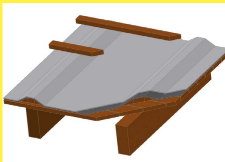
Na debnení – nezateplené podkrovie.
