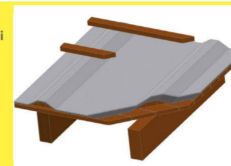
Na debnení – nezateplené podkrovie.
