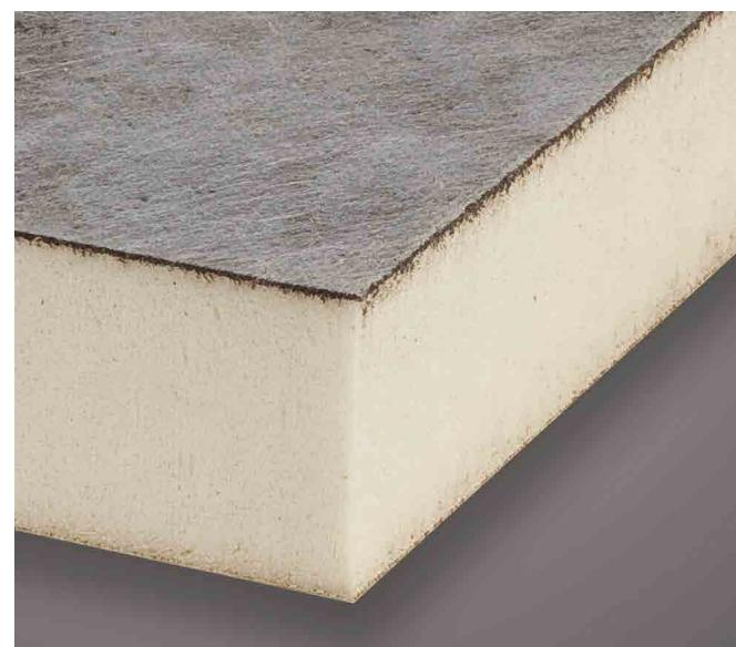
Jadrom tepelnoizolačnej dosky TERRANterm je PIR, ktorý je pokročilejšou verziou polyuretanu s oveľa lepšími fyzikálnymi a chemickými vlastnosťami. Štruktúra izolantu obsahuje miliardy uzavretých buniek. Súčinatel teplnej vodivosti závisí od hrúbky izolantu je  $0,022 - 0,025 \text{ W/mK}$ .
