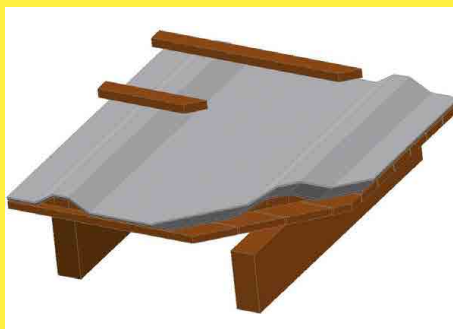
Na debnení – nezateplené podkrovie.
